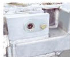
Bloc extrudé du hayon suspendu, avec tige fixe soumise au traitement (1144) pour l'élimination des contraintes, et embouts de graissage vissés.
