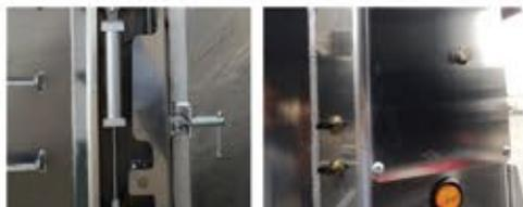
Priorité à la sécurité! La commande au sol pneumatique, conçue par MAC, permet au conducteur de passer de l'ouverture à bascule à l'ouverture latérale en restant au sol, sans avoir à grimper sur le côté pour engager les goupilles.
