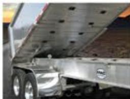
Le dessous de caisse à panneaux privilégie une excellente résistance au vent, une utilisation optimale de la remorque et minimise les frais d'entretien; il aide en outre à éliminer l'accumulation de débris routiers. Il est formé par des panneaux d'aluminium extrudé à âme creuse de 12 po (30 cm) par 3 1/2 po (9 cm) de profondeur et un plancher intérieur de 0,250 po (6 mm).
